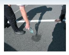
Infiltration des eaux pluviales sur les enrobés poreux.
